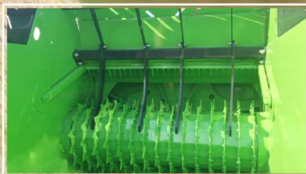
Controcoltello idraulico posizione disinserito Hydraulic knife switched off
