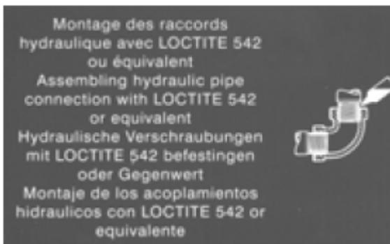
Монтаж гидравлических соединений производить при помощи герметика Loctite 542 или эквивалента.
